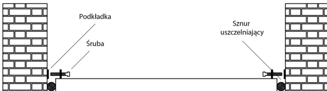
Rys. 1. Schemat przedstawiający prawidłowo zamontowane drzwi kominkowe IGNIF.
